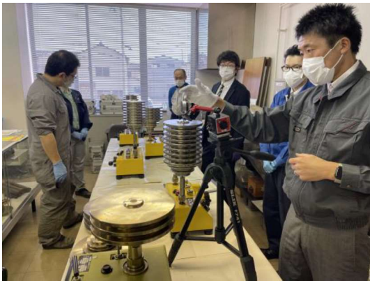
【重錘型圧力計の検査】
